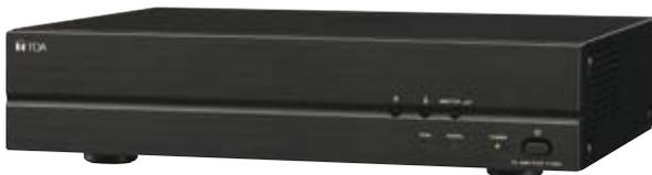
Der P-2240 bietet ein gutes Preis-Leistungsverhältnis und wird zusammen mit den A-2000 Serie Mischverstärkern eingesetzt. Der P-2240 bietet einen 100 V Eingang für den Anschluss von Lautsprecherlinien. Er kann auch ferneingeschaltet werden und dadurch unabhängig betrieben werden.
